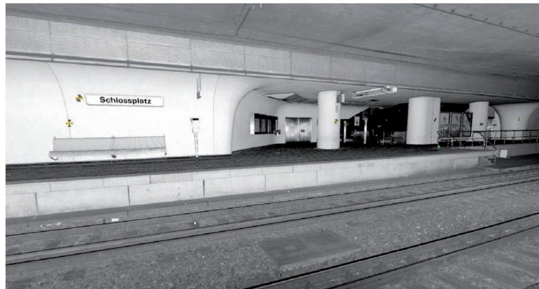
Objekt teilweise reflektiert und vom Gerät wieder empfangen. Neben der auf einen Millimeter genau detektierten Strecke zwischen Scannermittelpunkt und Objekt wird außerdem das Verhältnis zwischen der Stärke des ausgesandten und wieder empfangenen Laserimpulses gespeichert. Zusammen mit dem horizontalen und vertikalen Winkel kann so für jeden gemessenen Punkt eine 3D-Position relativ zum Laserzentrum berechnet werden. Als die Bahn gegenüber pünktlich ein-
