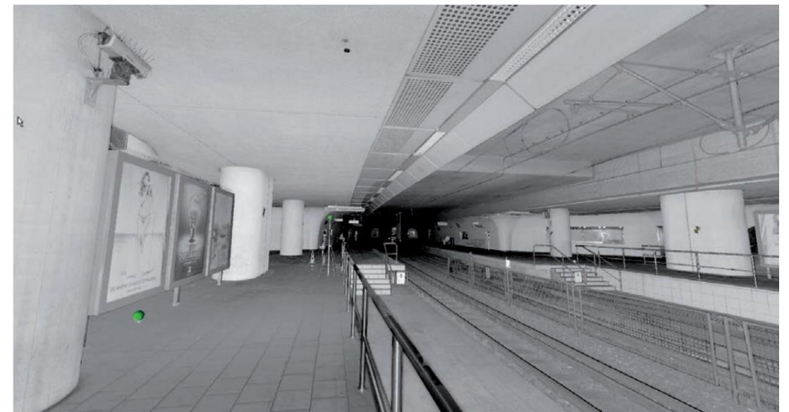
gen Punktwolke zusammengerechnet werden. Alle Punkte aller Scans befinden sich dann in einem einheitlichen Koordinatensystem. Weitere Arbeitsschritte sind das Herausfiltern unnötiger Messdaten wie z.B. den zufällig aufgenommenen Passanten. Dann erfolgt die Transformation der Punktwolke in das Landeskoordinatensystem sowie in das amtliche Höhensystem.
